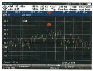
Signal reçu avec l'antenne contre le compteur. L'émission de France Inter est noyée dans le bruit. La raie à la fréquence de France Inter est à peine visible. Les messages horaires sont brouillés.
