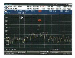
Signal reçu avec l'antenne dans la position de la photo. L'émission de France Inter est nettement visible, très au dessus du bruit. Le fonctionnement est satisfaisant.
